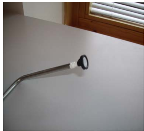
Figur 8.8 Filterelektrod enligt Semporemotoden. (foto: WSP)
