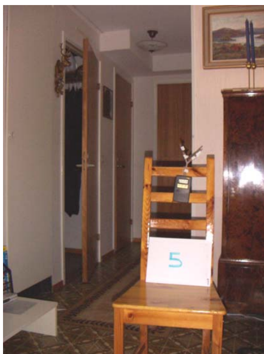
Figur 8.6 Aktiv luftprovtagning av rumsluft i en lägenhet med kolrör som adsorbent. Provpunkten märktes ut på ritning och fotograferades. (Foto: WSP)
