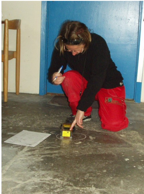
Figur 9.1 Mätning direkt på byggnadsmaterial med XRF-instrument, här utförd av Maud Söderberg. (Foto: Golder Associates)
