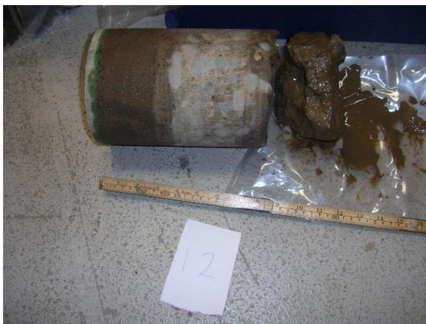
Figur 8.3 Stor borrkärna från betonggolvet i ett tidigare garveri, med flera olika skikt. (Foto: Golder Associates)
