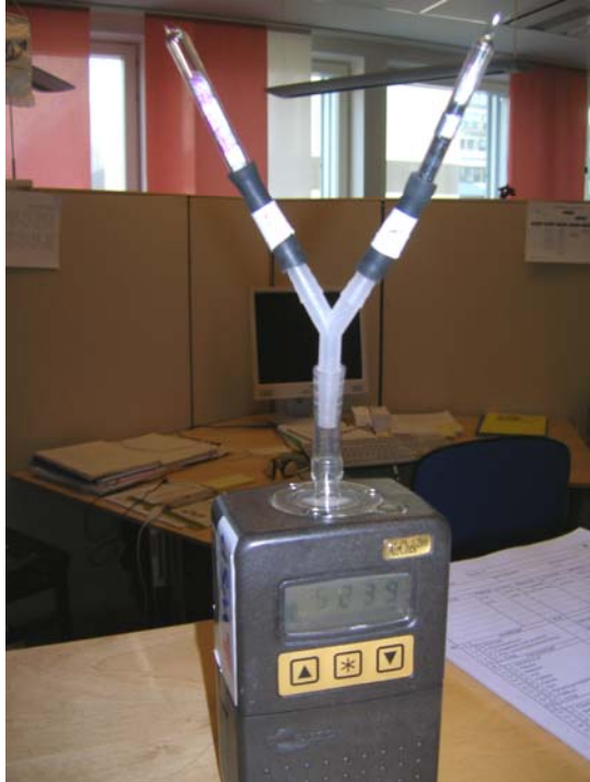
Figur 8.4 Aktiv pumpning med kolrör. (Foto: WSP)
