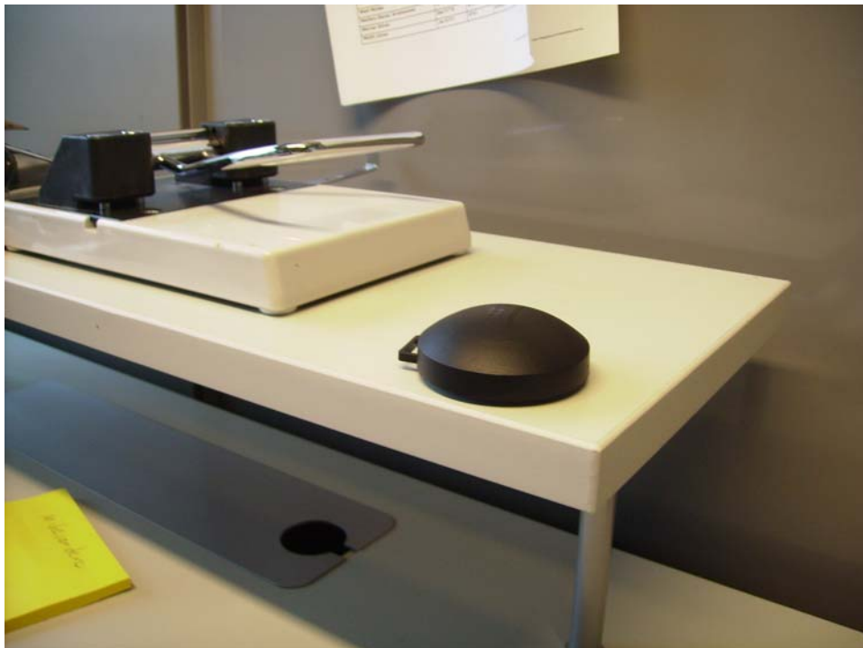
Figur 8.9 Radonmätning med spårfilm i kontorsbyggnad. (Foto: WSP)
