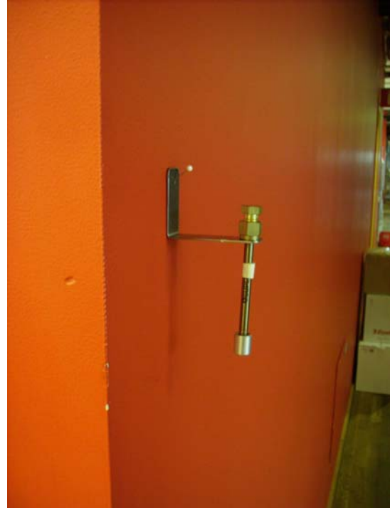
Figur 8.5 Passiv provtagning med Tenaxrör. (Foto: WSP)
